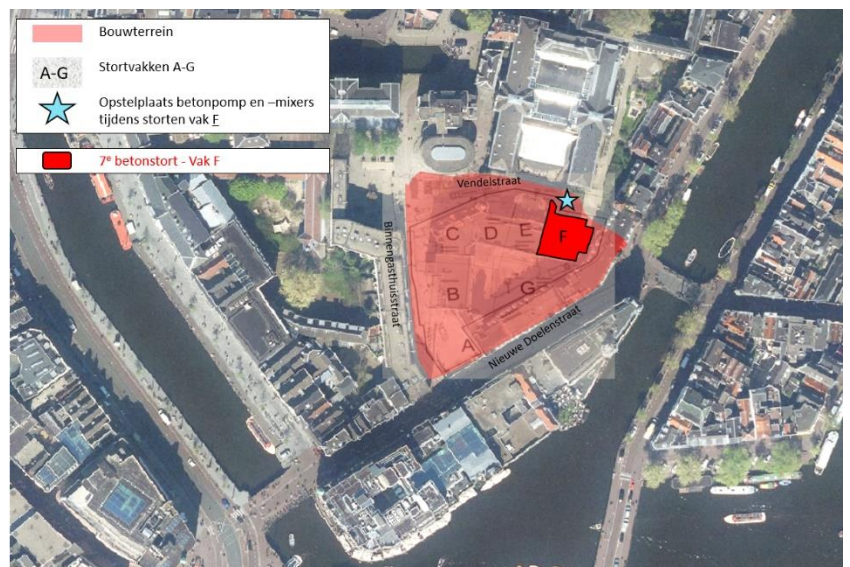
Figuur 2 – Locatie aanduiding betonstort
