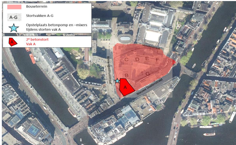
Figuur 1 - Locatie aanduiding betonstort
